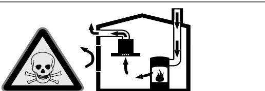
Raumluftabhängige Feuerstätten (z.B. gas-, öl-, holz- oder kohlebetriebene Heizgeräte, Durchlauferhitzer, Warmwasserbereiter) beziehen Verbrennungsluft aus dem Aufstellraum und führen die Abgase durch eine Abgasanlage (z.B. Kamin) ins Freie.
