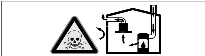
Vuurbronnen die de lucht in de ruimte verbruiken (bijv. apparaten die op gas, olie, hout of kolen worden gestookt, geisers, warmwaterketels) trekken de verbrandingslucht uit de opstellingsruimte en voeren de gassen via een afvoer (bijv. schoorsteen) af naar buiten.
