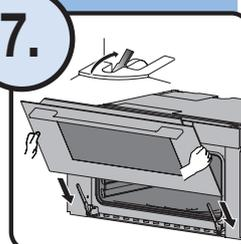
Gerätetür einsetzen, Bügel einklappen
