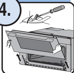
Bügel ausklappen, Gerätetür entfernen (empfohlen)
