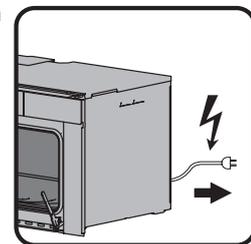
**Kabel gemäss Anschlussschild an Anschlussklemme anschliessen**
