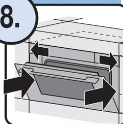
Gerät ganz einschieben, ausrichten
