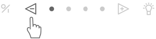
Drie groene LED's ⑤ geven stand één tot drie aan, een rode LED ⑥ geeft de 'POWER' stand aan. De 'POWER' stand wordt enkel gebruikt bij een sterke ontwikkeling van geur, rook of damp. Rekening houdend met de grote afvoer van lucht bij deze stand, moet het gebruik tot een minimum herleid worden. De 'POWER' stand keert na 6 minuten automatisch terug naar snelheid drie.
