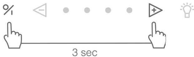
Zum Ausschalten der InTouch-Funktion die Taste ① und die ② Taste gleichzeitig 3 Sekunden lang gedrückt halten. Die zweite und dritte LED blinken zur Bestätigung dreimal. (Das Gerät muss ausgeschaltet sein).
