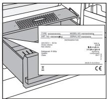
Het typeplaatje bevindt zich aan de binnenzijde van het apparaat (zie afbeelding).
