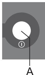
**Het apparaat inschakelen:** Druk op knop **A** en houd deze 3 seconden ingedrukt.
