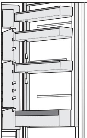
De deurvakan zijn in hoogte verstelbaar. Til het vak uit de groef en plaats het in de gewenste positie. De maximale belasting van elk vak is 5 kg. Het onderste deurvak is geschikt voor flessen.
