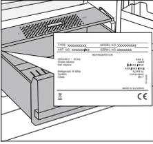
Het typeplaatje bevindt zich aan de binnenzijde van het apparaat (zie afbeelding). Op dit plaatje staat informatie over spanning, bruto- en netto-inhoud, type en hoeveelheid koelmiddel, en informatie over de klimaatklasse.
