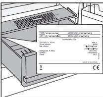
Het typeplaatje bevindt zich aan de binnenzijde van het apparaat (zie afbeelding).
