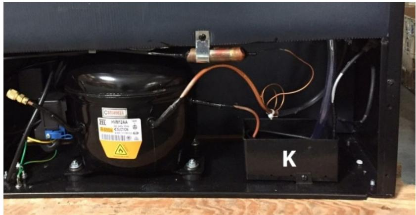
Entfernen Sie gegebenenfalls mit einem Schwamm das Kondenswasser aus dem Kondenswasser-Auffangbehälter. Dieser befindet sich auf der Rückseite des Gerätes unten rechts. Metallabdeckung bitte dafür entfernen und anschließend wieder festschrauben.
