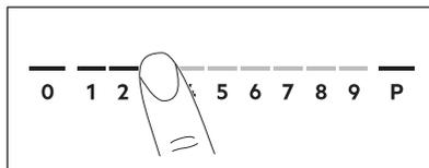
Als u eenmaal een pan op de zone zet en de kookstand instelt, blijft deze gedurende 2 minuten gelijk nadat u de pan heeft verwijderd. De regelbalk en de aanduiding van de kookzone knipperen gedurende 2 minuten. Als u de pan binnen deze tijd weer op de kookzone plaatst reactiveert de kookstand. Zo niet, wordt de kookzone gedeactiveerd.
