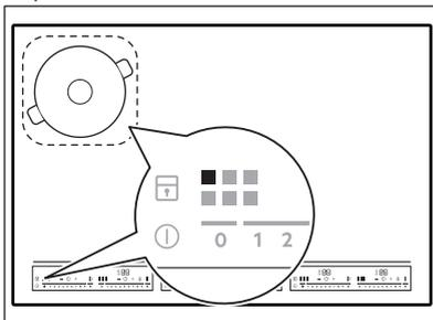
Jedes Quadrat auf dem Bedienfeld kennzeichnet eine Kochzone auf der Induktionskochfläche. Die Zonenanzeigen zeigen an, welche
